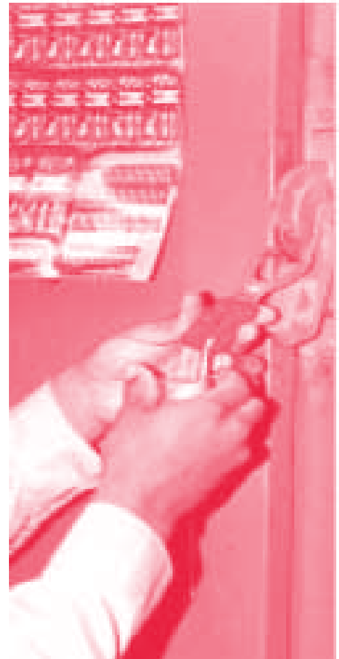
Με το ομαδικό-πολλαπλό κλείδωμα δεν μπορεί να γίνει επανεκκίνηση του εξοπλισμού, αν πρώτα όλοι οι εργαζόμενοι δεν ξεκλειδώσουν τα λουκέτα τους.
